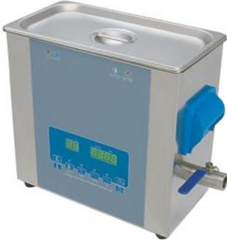
El baño ultrasónico **Shesto UT8061** está diseñado para limpiar en profundidad piezas electrónicas, instrumental y otros objetos complejos mediante ondas ultrasónicas combinadas con calor.
